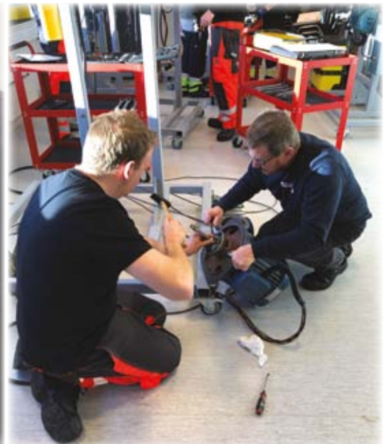
Viktor og Espen demonterer en Kone heismotor. Bildet t.v.: Ole Christian og Hans demonterer en Demag heismotor.
