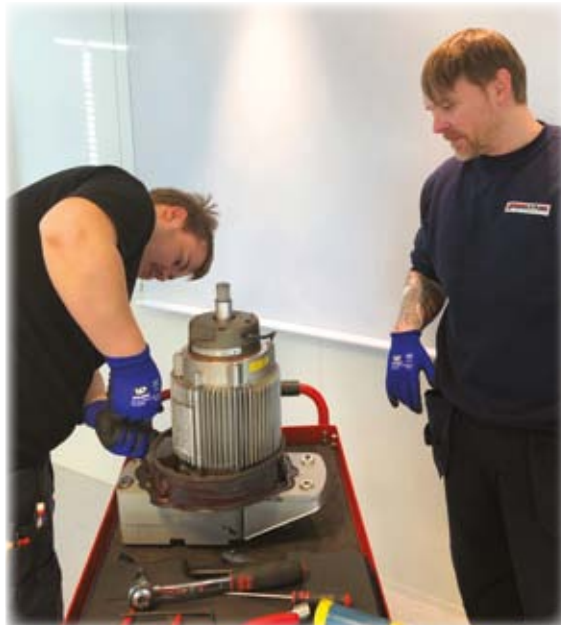
Viktor og Espen demonterer en Kone heismotor. Bildet t.v.: Ole Christian og Hans demonterer en Demag heismotor.
