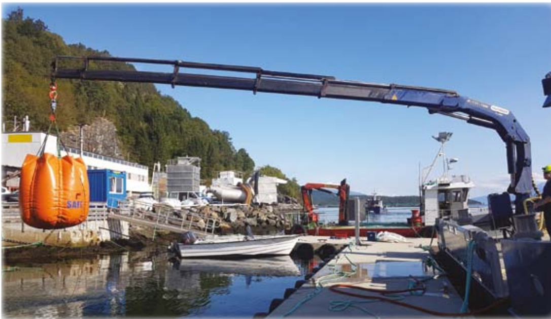
Her utfører KIS MARITIME AS 5. årig lasttest på kranene til Eide Fjordbruks båter Erling Viking og Frode Viking.
