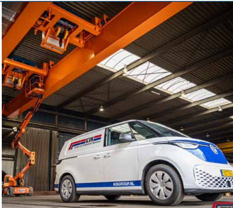
Spesialtilpasset 63 tonns traverskran.
