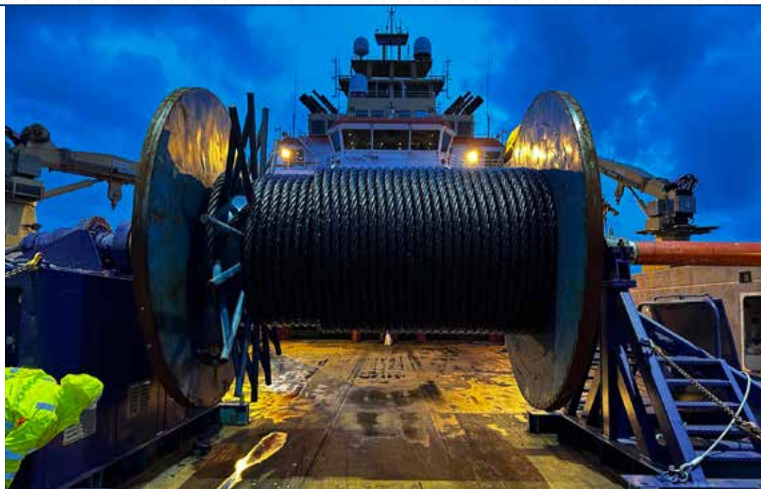
Bytte av 90 mm slepewire på 300 tonns spoleapparat.
